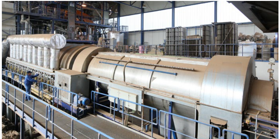
In Hochleistungs-Brennöfen wird das Rohmaterial bei 900 °C zu Blähglasgranulat gesintert
